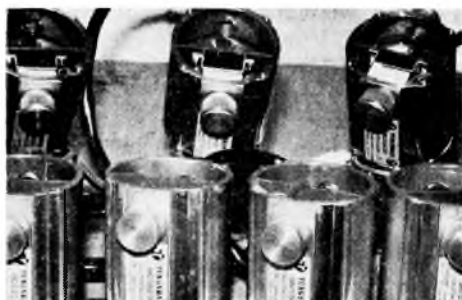
25-3. ábra. Poliuretán öntőgyantával tokozott impulzus-transzformátorok
