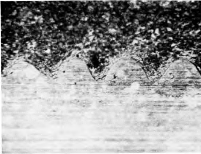
17-6. ábra. Ezüst – réz plattírozásnál kialakított hullámkötés a lemezek határfelületén
