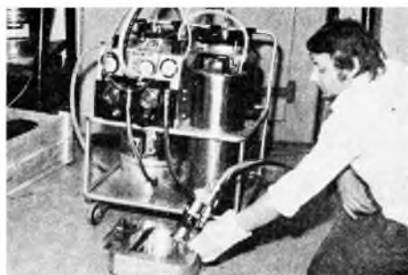
25-4. ábra. Fojtótekercs Plateco R 33 típusú célgéppel való kiöntése
