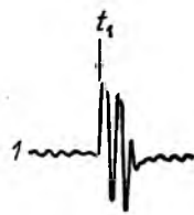
4-9. ábra. Fogyasztói zárlat 0,2I_n értékű lomha biztosítón keresztül
